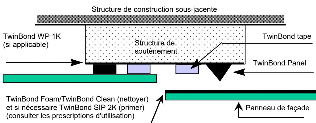
Pour assurer une bonne ventilation et une évacuation de l'éventuelle humidité derrière les panneaux de façade, aucun lien adhésif horizontal appliquée. La colle offre les performances citées dans le tableau 1 de cette attestation avec certificat du produit en cas d'une largeur minimale (en situation installée) de 12 mm et d'une épaisseur de 3 mm. Le cordon de colle est appliqué sur la structure de soutènement pendant une seule opération sur toute la hauteur de des panneaux de façade à monter.
